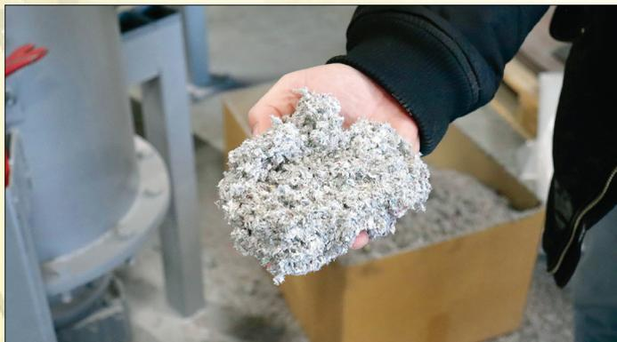
Einige Dämmstoffe – wie zum Beispiel Cellulose – verfügen über eine hohe Wärmespeicherkapazität. Werkfoto: Climacell
