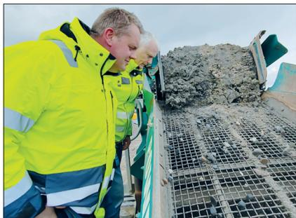
Hier wird der ausgebaggerte Strandsand in einem Siebdurchgang zweifach gesiebt.
