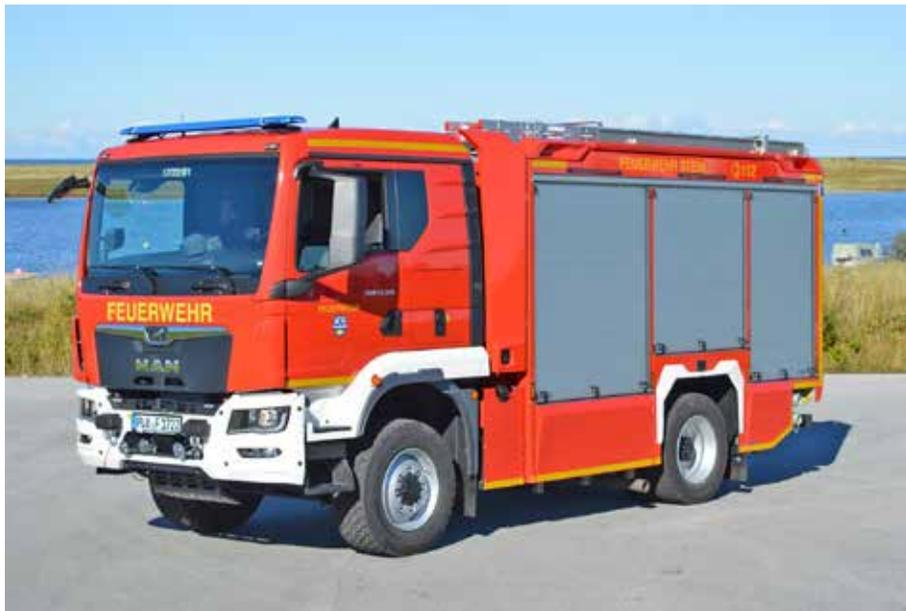
**Das neue Tanklöschfahrzeug hat 3.500 Liter Wasser an Bord. Damit ist die Feuerwehr Stein jetzt so gut gerüstet, dass sie vor dem Eintreffen eine Nachbarwehr einen schlagkräftigen Löschangriff starten kann.**
