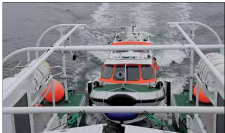
Das Tochterboot gleitet während der Fahrt auf die Rampe des Rettungskreuzers.
