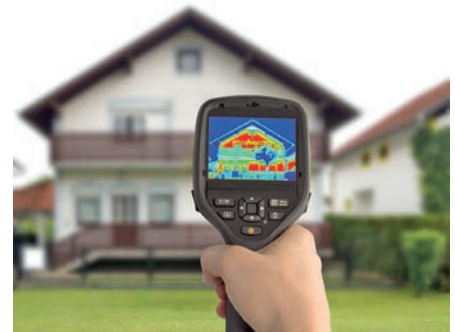
Die Wärmebildkamera zeigt, wo es im Haus energetischen Sanierungsbedarf gibt. Mit einer richtigen Dämmung können die Wärmeverluste vermieden werden.
