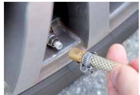
Achtung bei der Reifenpanne: wer Pannenspray einfüllt, muss den Reifen danach austauschen, eine Reparatur ist dann nicht mehr möglich.
