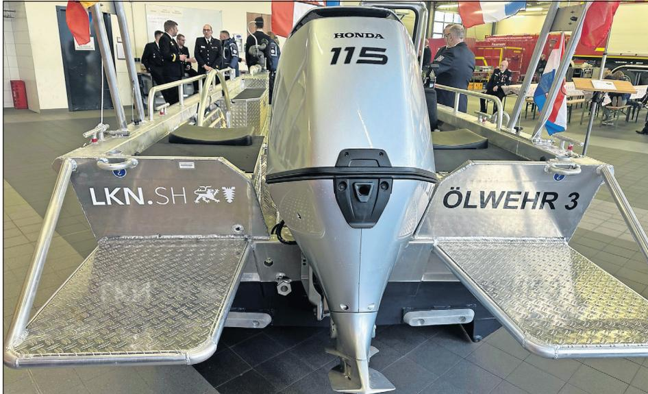
Das 6,50 Meter lange Boot mit einem 115-PS-Außenmotor hat einen fest eingebauten Löschmonitor und eine große Bugklappe für Rettungseinsätze.
