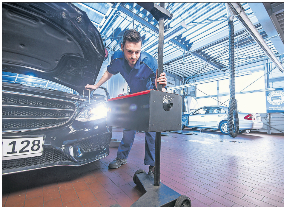
Beim Licht-Test werden neun Beleuchtungspunkte auf Sicht und Funktion sowie die Einstellung aller Lichtsysteme gecheckt. (Foto: ProMotor/T.Volz)
