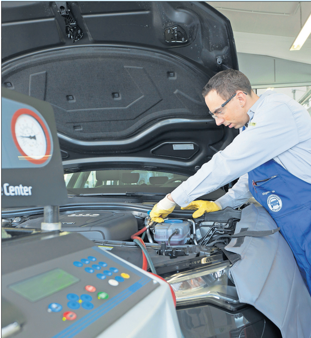
Die Klimaanlage sollte alle zwei bis drei Jahre gewartet werden, spätestens aber, wenn ein Nachlassen der Kühlleistung spürbar wird. (Foto: ProMotor/T.Volz)
