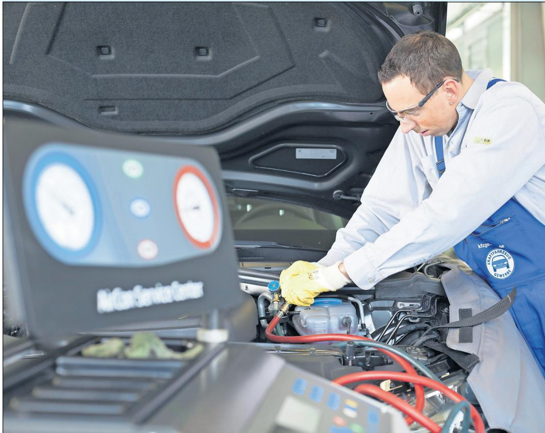
Ein Fachbetrieb sollte die Klimaanlage in regelmäßigen Abständen (etwa alle zwei Jahre) entleeren und neu befüllen sowie den Filtertrockner auswechseln. (Foto: ProMotor/T. Volz)
