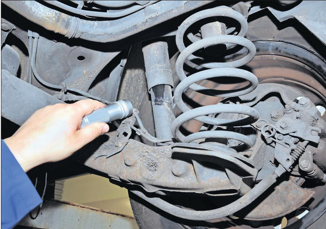
Stoßdämpfer gehören ab 60.000 Kilometern Fahrleistung auf den Prüfstand. (Foto: ProMotor)
