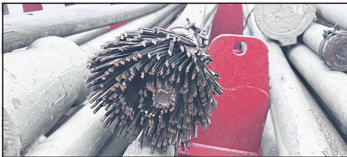
Einzelteile eines alten ausgebauten Seils.
