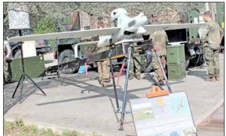
**Die Drohne „Luna“ hat eine Reichweite von 80 Kilometern und fliegt in einer Höhe bis zu 4000 Meter.**
