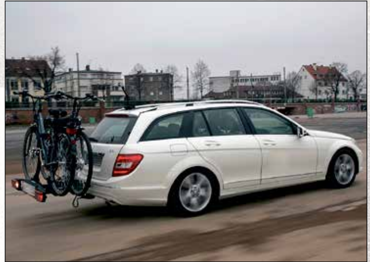
Um Fahrradträger sicher zu befestigen, werden in der Regel speziell auf den jeweiligen Fahrzeugtyp abgestimmten Grundträger benötigt.
